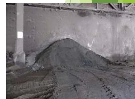
圖6. 氧化渣堆置(浮吸完成)
